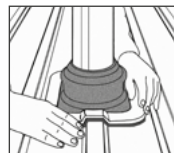
4. DEKTITE® vyformujete na profil
