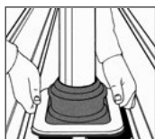
2. DEKTITE® nasadíte na profil a označíte
