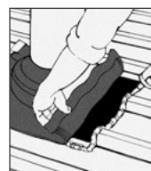
5. Naniest' tesniaci tmel EJOPLAST na plech a DEKTITE® vyformujete na profil
