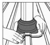
4. DEKTITE® vyformujete na profil
