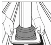
2. DEKTITE® nasadíte na profil a označíte
