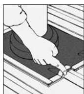
2. DEKTITE® nasadíte na profil a označte
