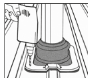
5. DEKTITE® so skrutkami, alebo rozpernými nitmi upevníte.
